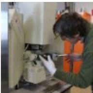
Seit kurzem ist das Department für Lithosphärenforschung auf dem modernsten Stand der Technik: Mit einer neuen Elektronenstrahlmikrosonde im Wert von 1,3 Mio. Euro ist es den GeowissenschaftlerInnen möglich, Gesteine im sub-Mikrometer Maßstab zu analysieren.
